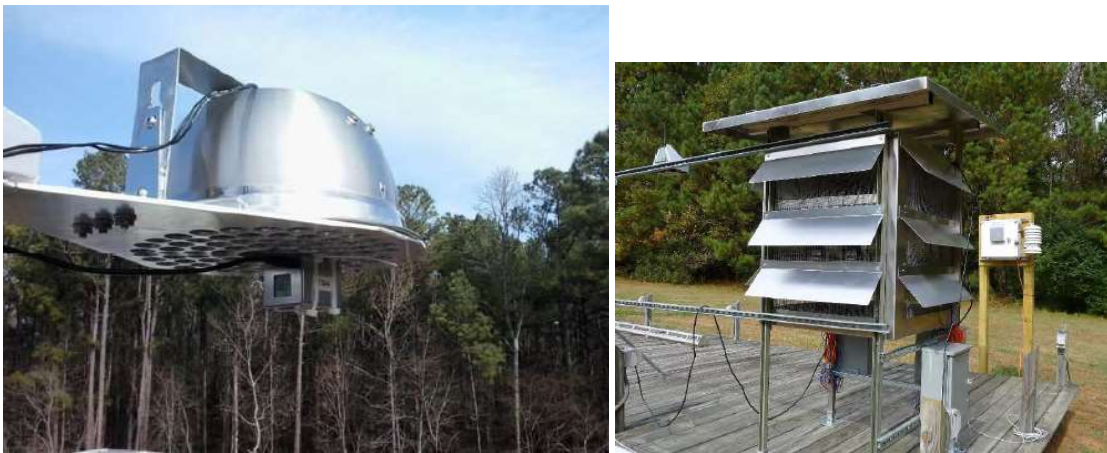
Figuur 6: Shelter voor veldtesten van stofsensoren en veldtesten van stof en andere sensoren
